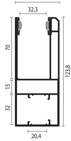
Die Distanzkammern der Führungsschienen sorgen dafür, dass das gesamte Element 8 mm Distanz zum Sturz erhält. Bei dem Führungsschienenmaß = Lichte Höhe + 70 mm ist jederzeit garantiert, daß der Endstab nicht im Sichtbereich steht.
