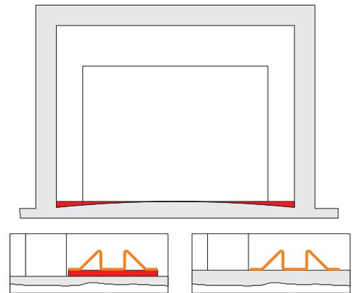
Die Befestigungsauflage für die Bodenschiene muß gerade sein. Gegebenenfalls muß die Bodenschiene unterfüttert oder der Boden ausgeglichen werden.
